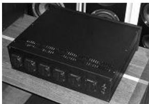
3x 4 Filter-Module (parallel geschaltet) auf 3x Ausgänge 230V
