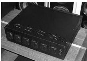
3x 3 Filter-Module (parallel geschaltet) auf 3x Ausgänge 230V
