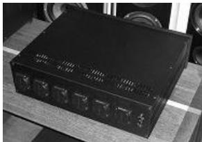
2x 4 Filter-Module (parallel geschaltet) auf 2x Ausgänge 230V
