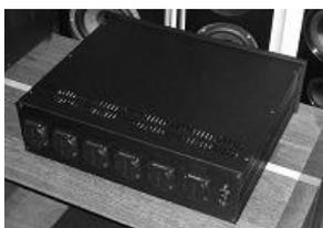
4x 3 Filter-Module (parallel geschaltet) auf 4x Ausgänge 230V
