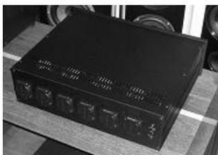
3x 2 Filter-Module (parallel geschaltet) auf 3x Ausgänge 230V
