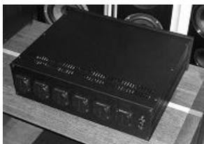
2x 3 Filter-Module parallel geschaltet auf 2x Ausgänge 230V
